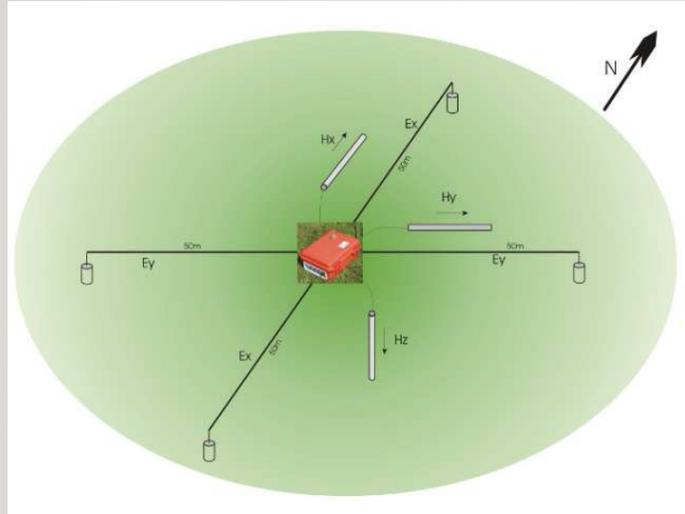
$$\begin{pmatrix} E_x \\ E_y \end{pmatrix} = \begin{pmatrix} Z_{xx} & Z_{xy} \\ Z_{yx} & Z_{yy} \end{pmatrix} \begin{pmatrix} H_x \\ H_y \end{pmatrix}$$
